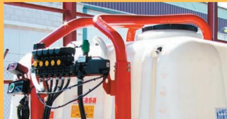
Chasis reforzado fabricado en perfiles abiertos que forman una estructura envolvente que otorga al conjunto una gran resistencia y solidez. Pintado al fuego tanto en sus caras exteriores como interiores.
