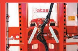
Elevador hidráulico con suspensión neumática, por colchones de aire de baja presión y baja frecuencia.
