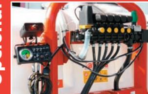
Regulador eléctrico: con caja de control en cabina, con corte general, presión de trabajo y corte por sectores con electroválvulas de retorno compensado.
