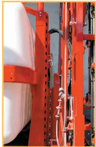
El nuevo sistema de elevación de barras mediante pistón de doble efecto y amortiguación de aire, posiciona la barra muy próxima al equipo, lo que reduce en gran medida los pesos y la oscilación de los brazos durante el proceso de aplicación.
