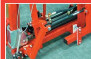
Corrector de pendiente: Sistema de nivelación de la barra mediante un pistón hidráulico de doble efecto y sistema antiretorno.
