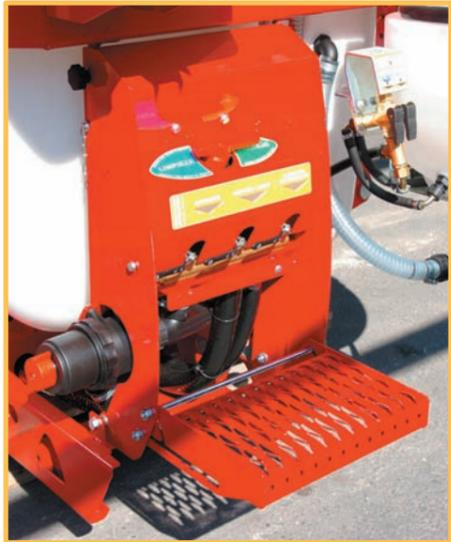
Los mandos auxiliares correspondientes a las funciones de lavado de circuito, de filtros y bomba, agitación y selección de depósito de aspiración, se encuentran agrupados en un único módulo abatible, de fácil acceso para su inspección en caso de necesidad.
