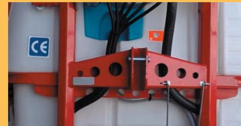
El sistema de conducción hidráulica se ubica por el interior del chasis. Los pasos disponen de anillas de goma para proteger de cortes la manguera.
