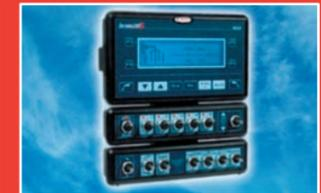
Computadora en cabina para controlar las secciones de barra y gestionar el sistema oleodinámico del conjunto barra y elevador. Visualización de litros / Ha, superficie tratada etc.
