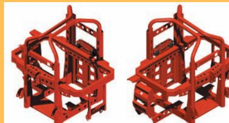
Las uniones se realizan por electrosoldadura, otorgando una gran resistencia al conjunto.
