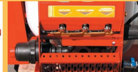
Los tradicionales filtros en línea son sustituidos por un filtro colocado antes del regulador de presión evitando de este modo una lectura de la presión de trabajo errónea.
