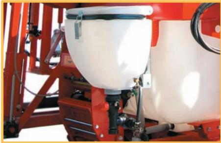
Llenador de producto CLEAN MIX, de 35 litros, con funciones 1) Mezcla 2) Rápido llenado de cisterna, 3) Lavado y apurado de envases, 4) Autolavado. Con junta de hermeticidad.
